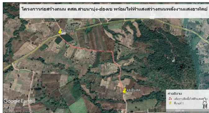
ภาพที่ 1 แผนผังแสดงจุดติดตั้งชุดโคมไฟฟ้าแสงสว่างถนนโดยใช้พลังงานแสงอาทิตย์ (LED)
